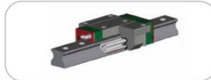
Todos los modelos de la serie M-One utilizan guías lineales de rodillos. Los rodillos de alta resistencia tienen una gran capacidad de carga. Además, las guías de rodillos están diseñadas para ofrecer una increíble resistencia a la inclinación. Con guías lineales de tipo rodillo de grado P, se garantiza la planitud perfecta de cada pieza mecanizada.
