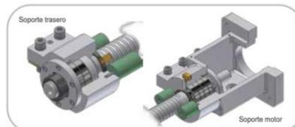
La rigidez es la clave para cortar más rápido, por eso utilizamos cuatro cojinetes de alta precisión para cargas pesadas en el soporte del motor y tres cojinetes de alta precisión para cargas pesadas en el soporte trasero. De este modo, hemos aumentado la rigidez del soporte del husillo a bolas en un 50% en comparación con las máquinas estándar del sector.
